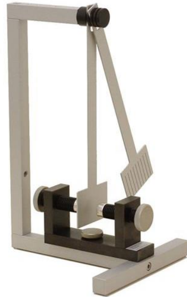
Abb. 5 Versuchsaufbau: „Induzierte Wirbelströme“
