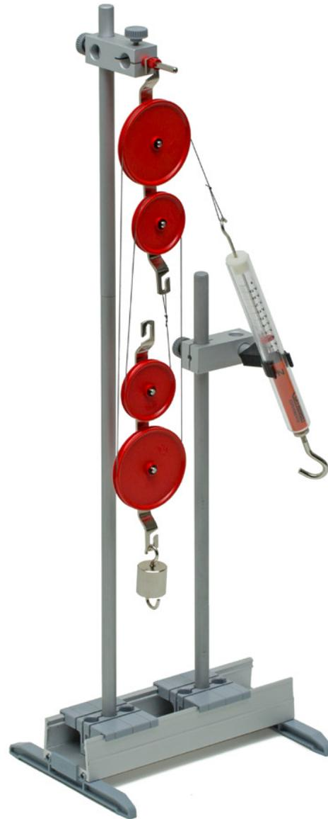
En accrocher une boucle au crochet du moufle supérieur, le faire passer dans les poulies des deux moufles comme sur l'illustration et accrocher son autre extrémité au dynamomètre. Tenir compte du poids du moufle inférieur lors de la mesure du poids du lest, ou ajuster le zéro du dynamomètre en ôtant le lest du moufle inférieur.
