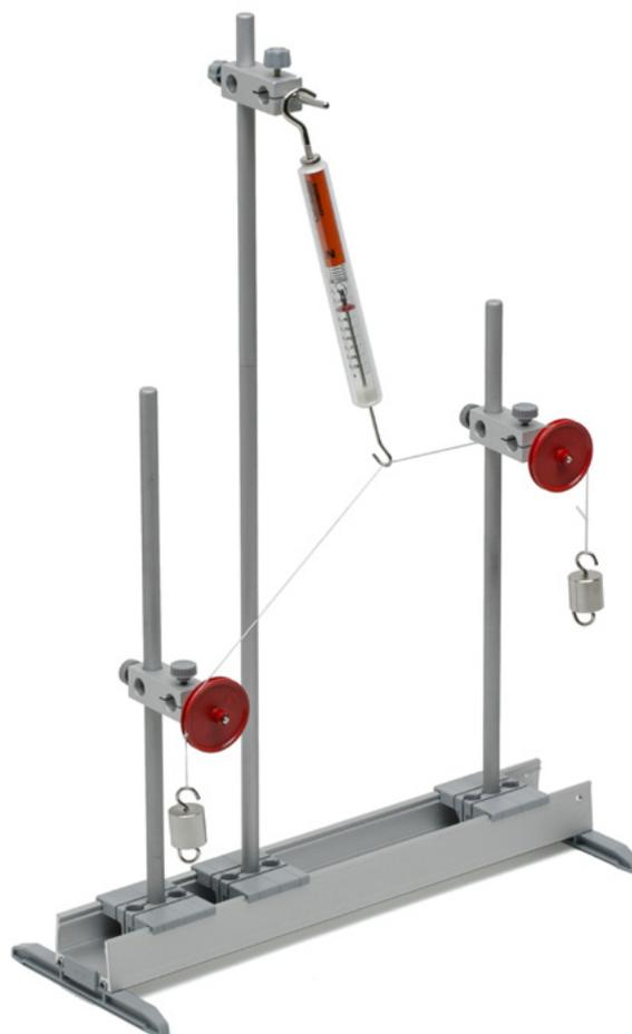
Nouer deux boucles aux extrémités d'une ficelle de 60 cm, la déposer sur les deux poulies et suspendre une masse à crochets à chaque extrémité. Faire une troisième boucle à un endroit quelconque de la ficelle entre les deux poulies et y accrocher le dynamomètre de telle manière qu'il tire vers le haut sur le nœud ainsi formé.
