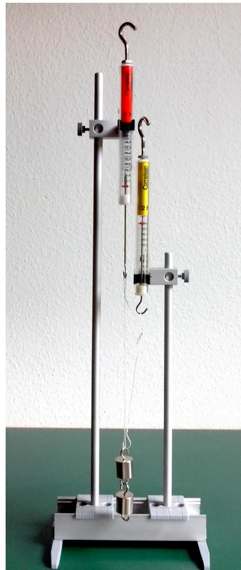
Lors de l'expérience, on monte le dynamomètre de droite en plusieurs étapes jusqu'à ce que la ficelle de gauche soit relâchée, tout en lisant à chaque fois les valeurs des forces et les reportant dans un tableau. On calcule ensuite les sommes des deux intensités :  $F_1 + F_2$ .
