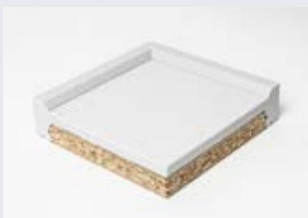
Est généralement utilisé comme plan de travail pour les éviers. Résistant à de nombreux produits chimiques. Le support de cette plaque est une plaque multiplex de 19 mm d'épaisseur, finie sur les deux faces avec du HPL. Une plaque de polypropylène est collée sur cette plaque. Avec bord relevé de 7 mm, également en polypropylène.
