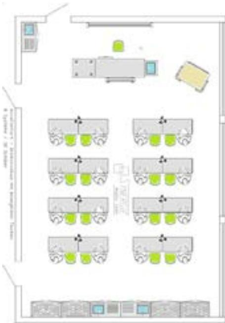
Disposition selon laquelle chaque rangée est équipée d'une colonne d'énergie.
