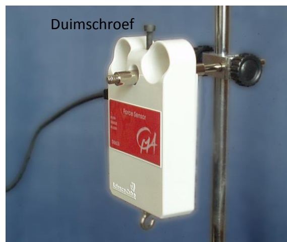
Figuur 2: Houd de krachtsensor in de hand of monteer hem aan een statief
